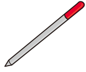
か 書けないボールペン おすじ ひ (折り筋を引くための さき 先のとがったもの)
